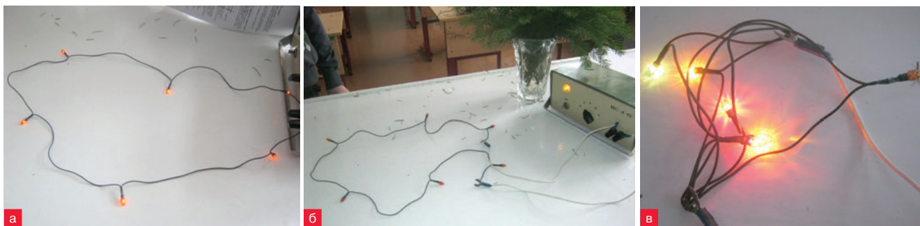
Работа 8. Если вывернуть одну лампочку гирлянды, то в цепи с последовательным соединением гирлянда гаснет (а, б), а в цепи с параллельным соединением – продолжает гореть (в)
